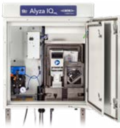
Alyza IQ PO 4 in der Ein-Kanal-Variante mit offenem Nassteil und Sicht auf das Photometer
