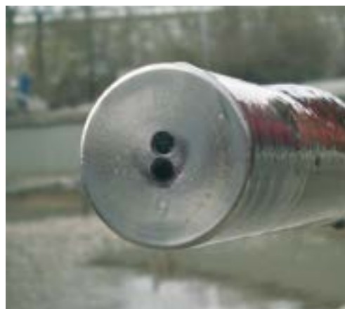
ViSolid® 700 IQ mit Ultraschall-Reinhaltung weist keinerlei Beeinträchtigung auf.
